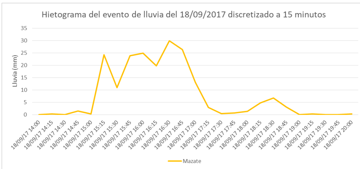
Figura 121. Estimación del hietograma del evento de lluvia del 18 de septiembre de 2017 en la estación Mazatenango.
